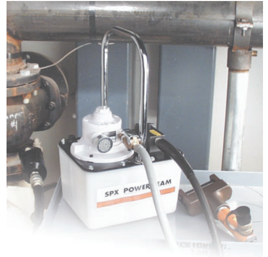
Насос PA17, подключенный к расширителю фланцевых соединений
